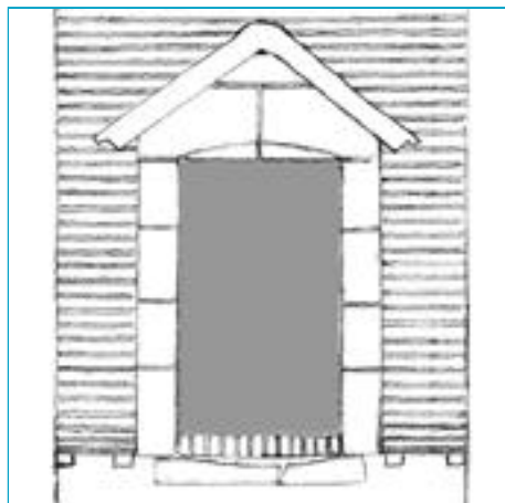
Variation de type de lucarnes * en pierre avec variation de la hauteur du plancher des combles et du positionnement de la lucarne par rapport à l'égout de toiture.
